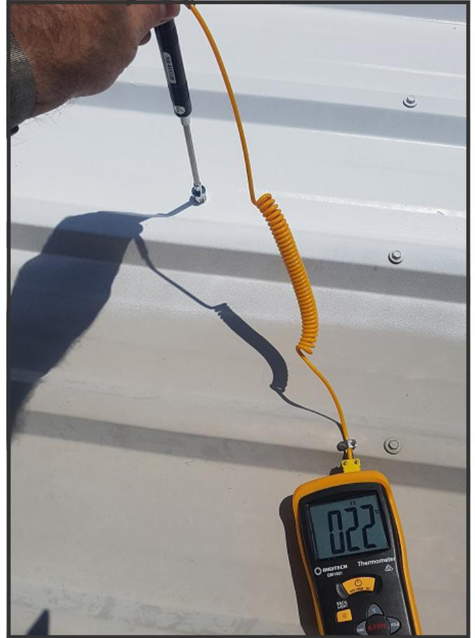
Standard-Dachanwendung: Die Temperatur sinkt von 46° C auf 22° C.
